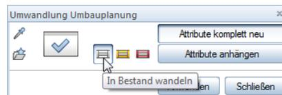
**Tipp:** Zur Kontrolle der einem Bauelement zugeordneten Umbaukategorie öffnen Sie das Kontextmenü des Bauteiles und aktivieren **Objektattribute zuweisen, modifizieren**. Im Dialogfeld wird die vergebene Umbaukategorie ausgewiesen und kann ggf. geändert werden.
