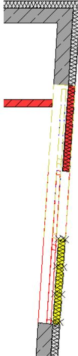
Der Neubau- und der Abbruchkörper für die Dämmschicht wurden erzeugt.
